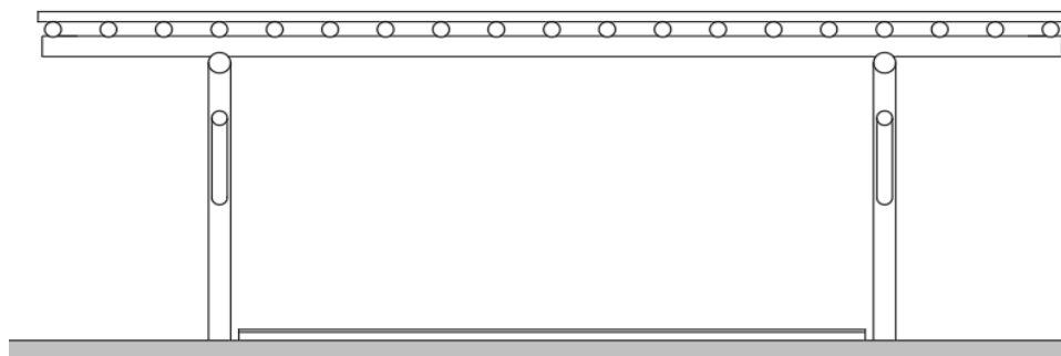
Imagem 06 – Vista lateral dos barracões (pergolados) com deck. Fonte: COPROJ-SEINF.
